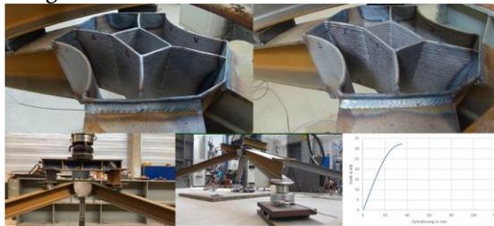
Versuch zur Tragfähigkeitsbestimmung eines WAAM-Knotens
