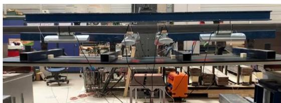
Versuch eines Sandwichbauteils unter erhöhter Temperatur
