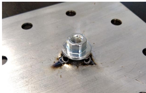
Geschweißte Mutter-Blech-Verbindung nach einem Auspressversuch zur Ermittlung geeigneter Schweißparameter
