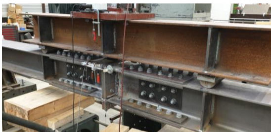
Versuchsaufbau zur Untersuchung eines vorgespannten Stimplattenstoßes
