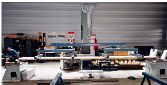
Bauteilversuch, Elementlänge 6 m
