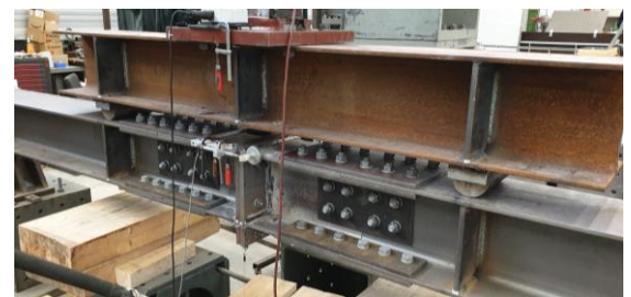
Versuchsaufbau zur Untersuchung eines vorgespannten Stirnplattenstoßes
