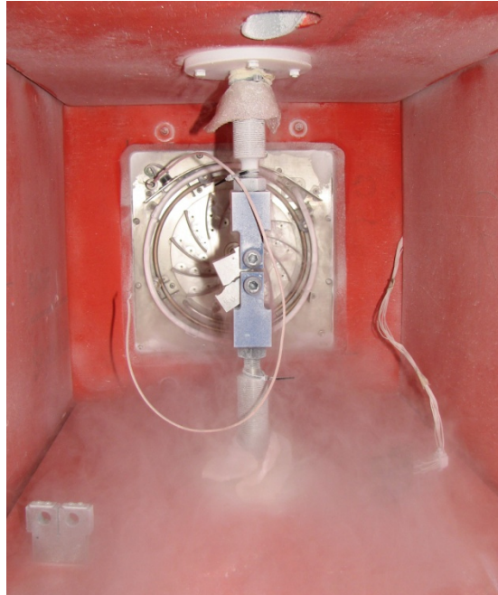
Bruchmechanikversuch: CT-Probe bei -140^{\circ}\text{C}
