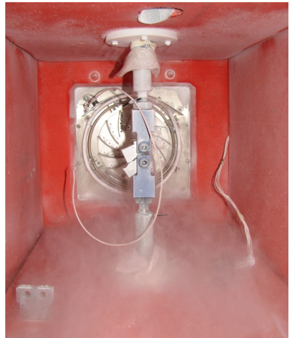
Bruchmechanikversuch: CT-Probe bei -140^{\circ}\text{C}
