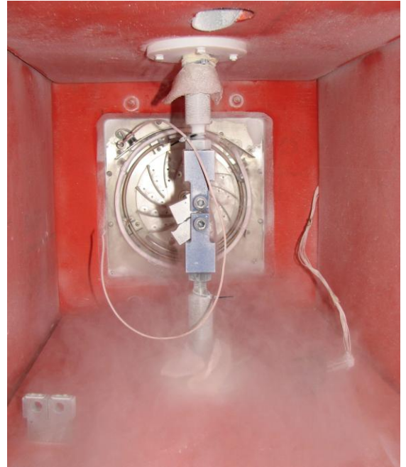
Bruchmechanikversuch: CT-Probe bei -140^{\circ}\text{C}
