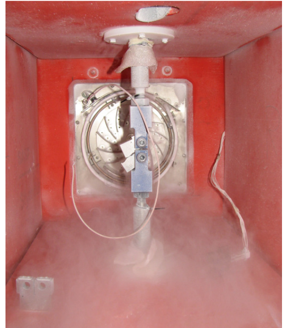
Bruchmechanikversuch: CT-Probe bei -140^{\circ}\text{C}
