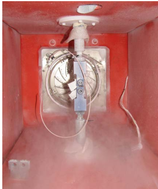
Bruchmechanikversuch: CT-Probe bei -140^{\circ}\text{C}
